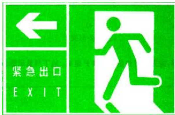
图 A2-4 图形、箭头和辅助文字组合形成的标志灯面板图示例
